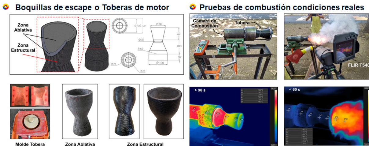
Figura 3. Desarrollo y prueba de componentes de propulsión a partir de materiales compuestos ablativos. Fuente: Autores.
