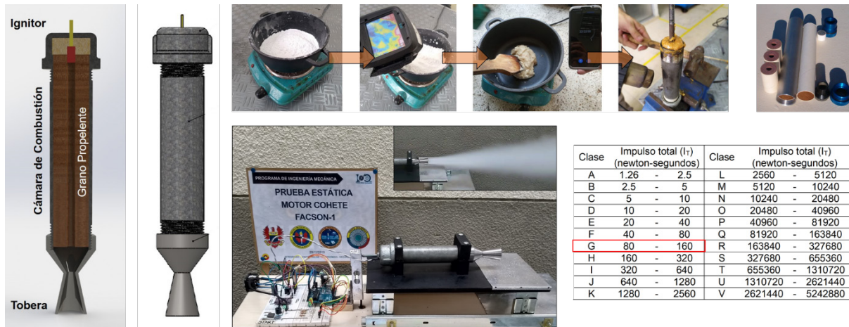
Figura 2. Diseño, construcción y prueba estática de motores cohete en la EMAVI-FAC. Fuente: Autores.
