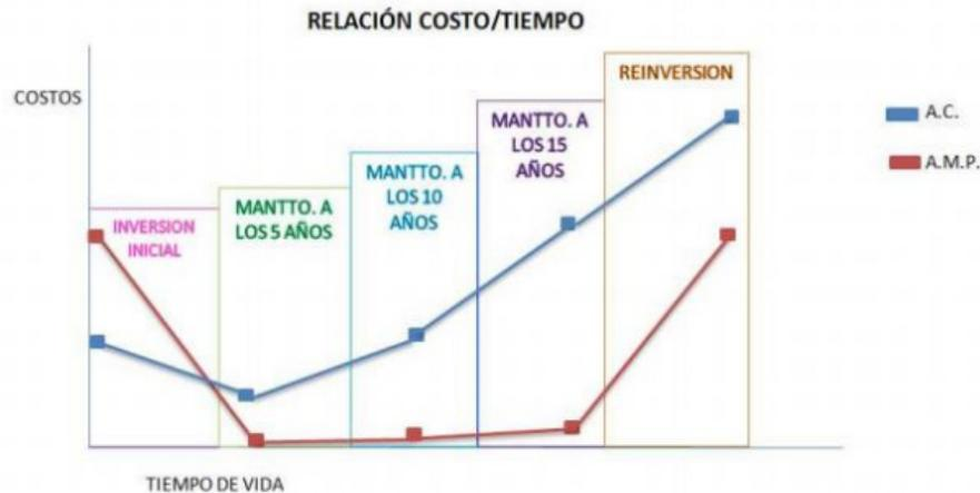
Figura 4. Comparación a nivel de costos entre la mezcla de asfalto común y la modificada. (Silvestre, 2017)
