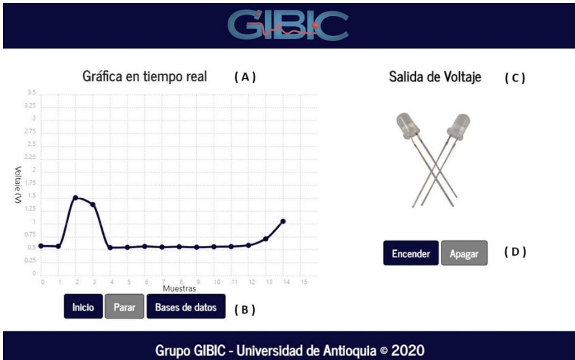
**Figura 2.** Aplicación Web desarrollada. (A) Región para la visualización de los datos en tiempo real. (B) Botones para la gestión de la visualización de la información. (C) Espacio destinado para el manejo de la salida de voltaje del pin del Onion Omega 2 (D) Botones para administrar los valores de voltaje de los pines.
