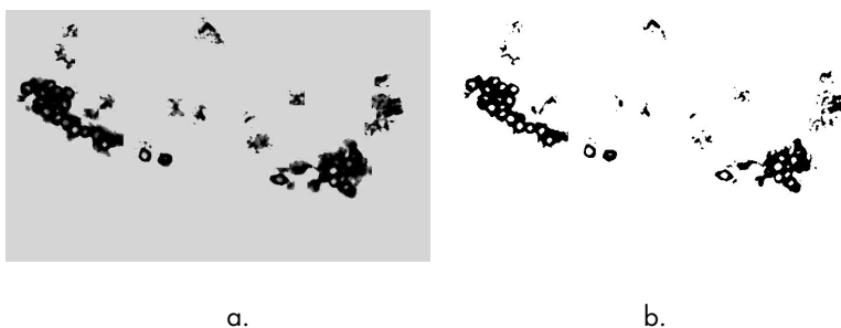
Figura 7. Detección de domos inversos. a. Resultado de la transformación Domo 3D. El contraste fue ampliado para permitir la observación de los domos inversos. b. Imagen binarizada de los domos inversos, usados como semillas.
