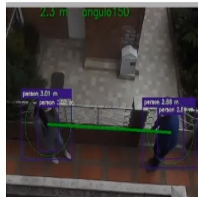
Figura 8. (Izq.) Número de cuadros procesados por segundo. (Der) Medición del distanciamiento
