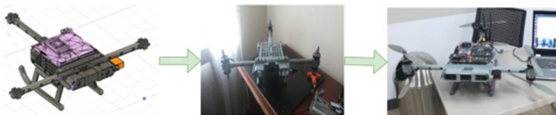
Figura 1. Proceso de impresión 3D del Dron
