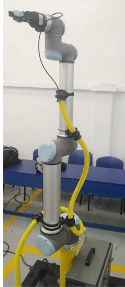
Figura 2. Brazo robótico UR10
