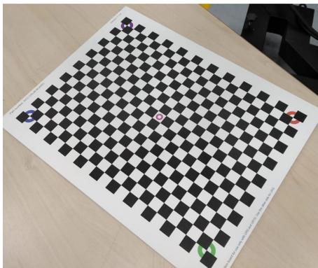
Figura 6. Matriz de calibración óptica. Wrist Camera, ROBOTIQ
