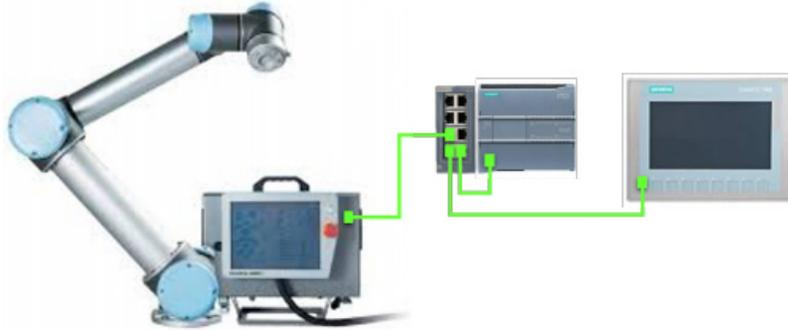
Figura 8. Topología de comunicación PROFINET.
