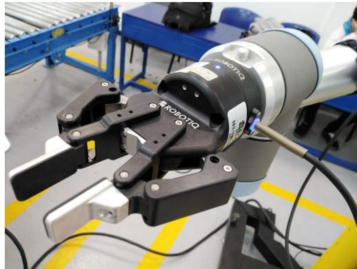
Figura 4. Gripper instalado como efector final en el brazo del laboratorio.
