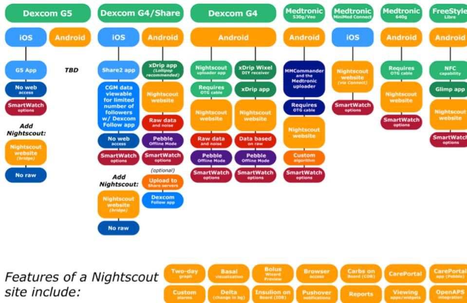
Figura 1. Esquema de operación del Nightscout ()
