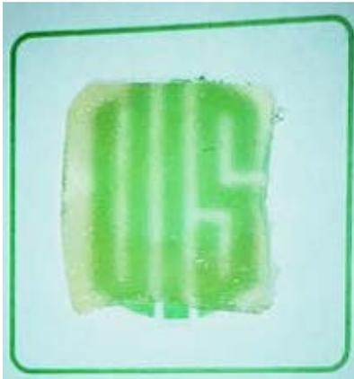
**Figura 5.** Obtención de madera ópticamente transparente con una transmitancia de 71% (autores).
