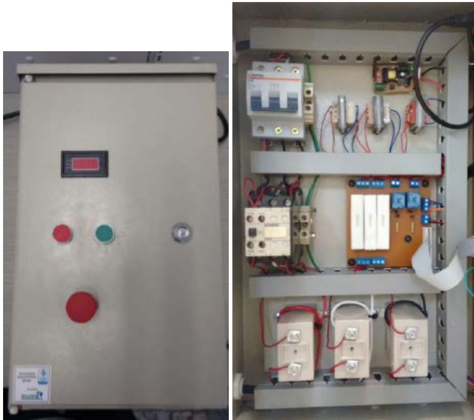
Figura2. Modelo definitivo del banco de pruebas para máquinas eléctricas de baja potencia
