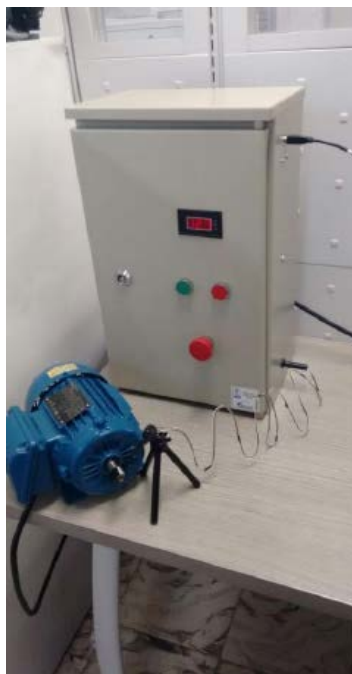
Figura3. Modelo definitivo del banco de pruebas para máquinas eléctricas de baja potencia- pruebas iniciales
