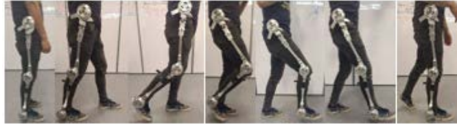
Figura 3. Grados de libertad que permite la estructura en el plano sagital en el ciclo de marcha
