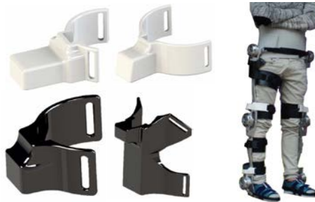
Figura 5. Diseño de sujeción del exoesqueleto adaptado a la musculatura humana
