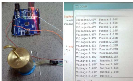
Figura 8. Caracterización del sensor de fuerza FSR
