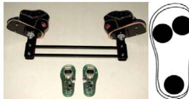
Figura 2. Plantilla Padmapada y ubicación de sensores.
