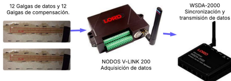
Figura 3. Sistema de adquisición de datos y galgas para concreto usadas.
