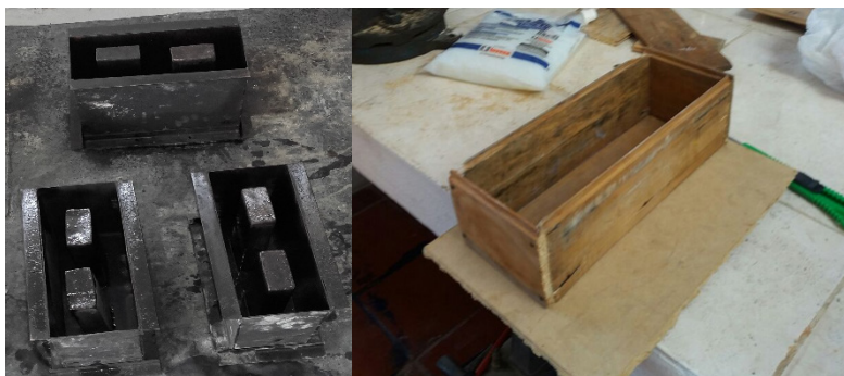
Figura 1. Formaletas para las unidades de mampostería, bloque de Perforación vertical y Bloque macizo. Fuente: (Montealegre & Carvajal R. , 2018)
