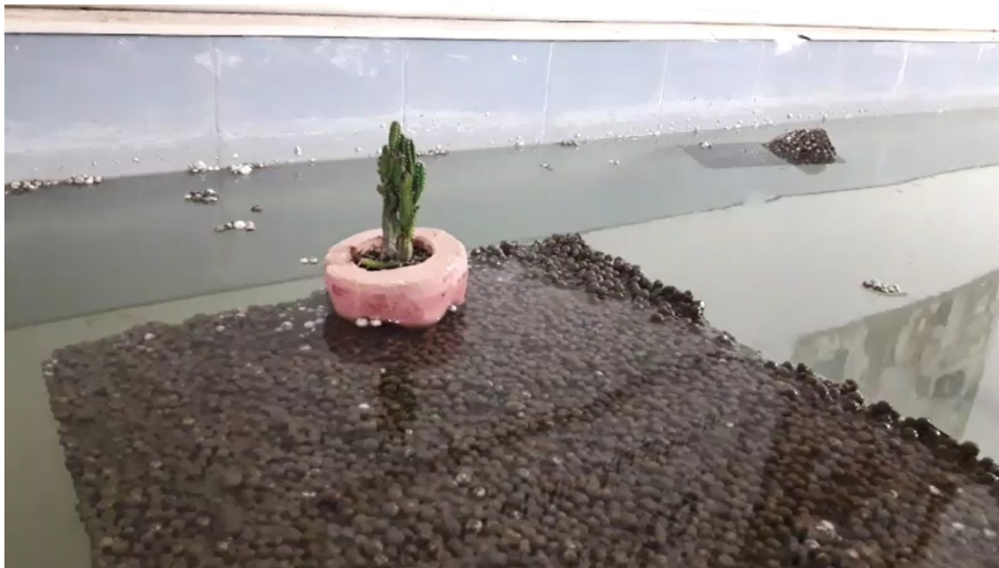
Figura 2. Prueba 02, mezcla de concreto liviano con perlas de poliestireno Fuente: propia, 2018
