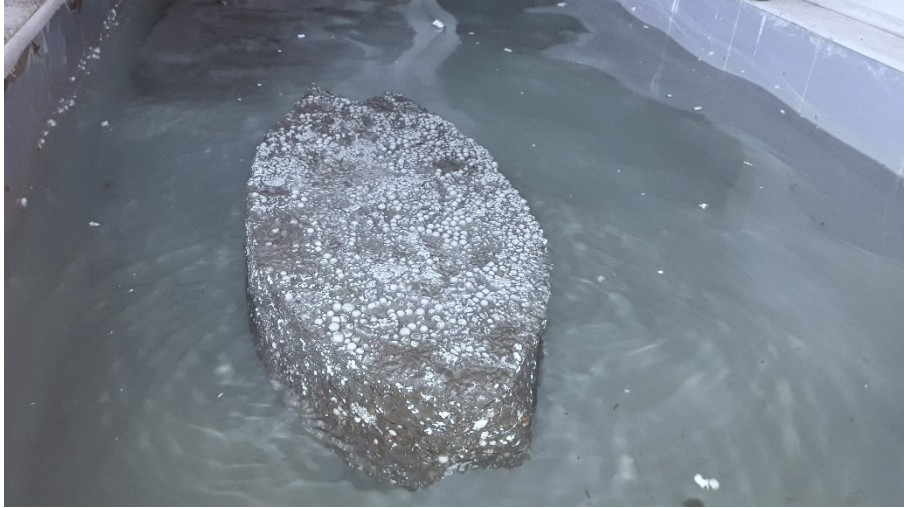
Figura 1. Prueba 01, mezcla de concreto liviano con perlas de poliestireno Fuente: propia, 2018
