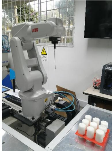
Imagen 4. Robot ABB irb 120, cilindros de acetal y molde.
