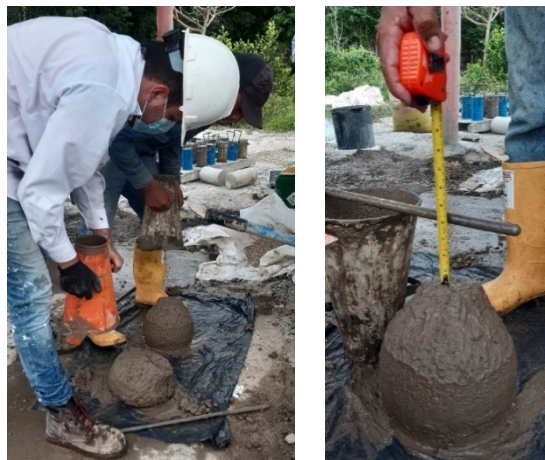
Figura 3. Prueba de Asentamiento
