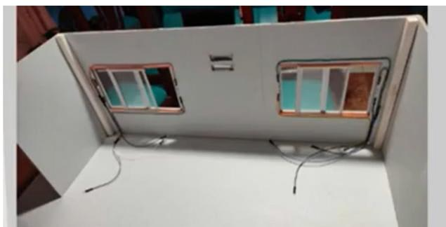
Cada uno de estos puntos de acceso cuenta con un sensor magnético que en una implementación futura en una edificación real, empleara sensores comerciales, que para efectos de pruebas funcionales fueron reemplazados por Reed Switch, a su vez los sistemas de cierre y apertura que emplearían cantoneras magnéticas o motores AC, fueron reemplazados para las pruebas a escala, por
