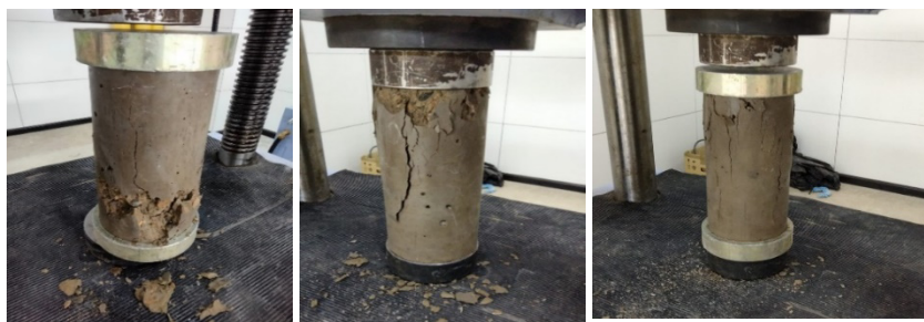
Ilustración 4 Cilindros patrón fallados a los 7 días
