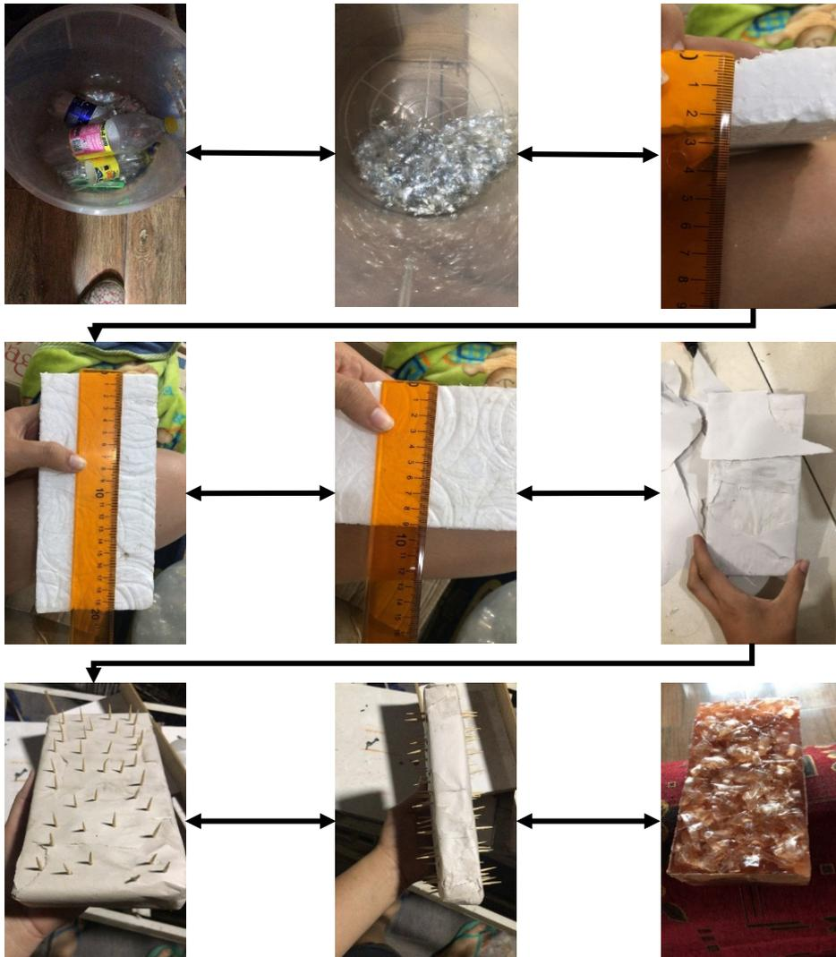
Figura 4 Proceso de elaboración de ladrillo.
