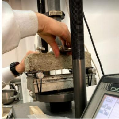
Figura 4. Ensayo de flexotracción
