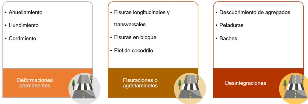
**Figura 3. Tipos de fallas más comunes en pavimentos flexibles.**
