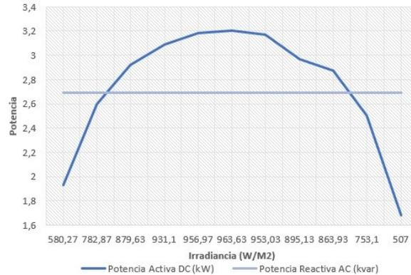
Figura 3. Comportamiento del sistema fotovoltaico Grupo 3, elaboración propia
