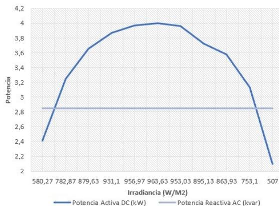
Figura 2. Comportamiento del sistema fotovoltaico Grupo 2, elaboración propia
