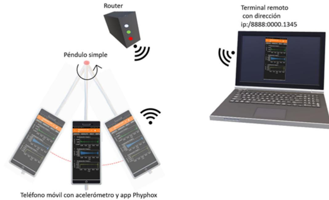
Figura 3. Esquema de experimento péndulo simple donde se miden los datos con el acelerómetro del celular. Se usa una aplicación móvil, *Phyphox*, la cual transmite los datos usando comunicación wifi y una dirección IP que permiten la visualización remota del experimento.
