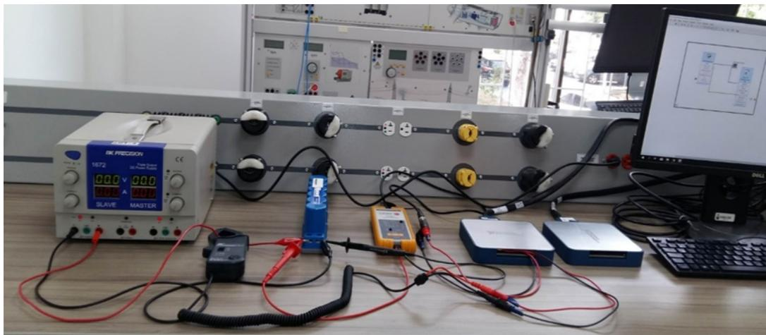
**Figura 5.** Módulo de laboratorio para caracterización de supercondensadores.
