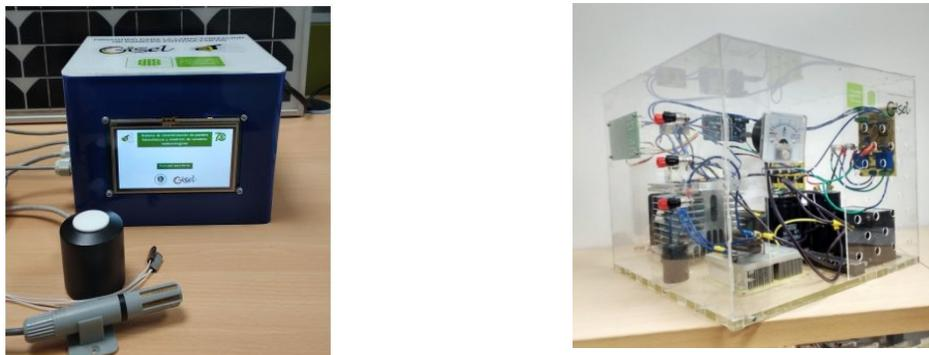
**Figura 1.** Prototipo para la caracterización de paneles fotovoltaicos
