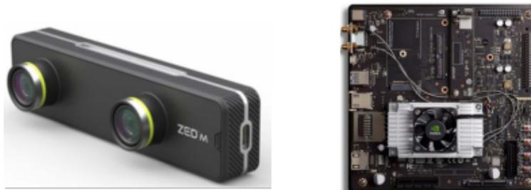
Figura 2. Cámara Stereolabs y Jetson TX2
