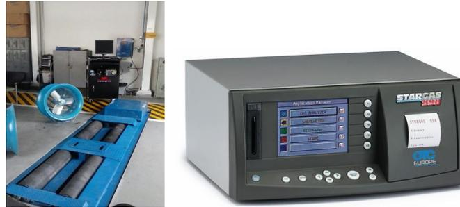
*Figura 2* Dinamómetro de rodillos y medidor de emisiones gaseosas
