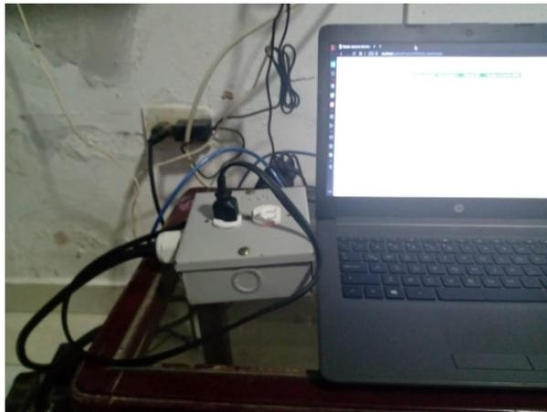
Fig. 2. Prototipo de Medición de Energía conectado a un equipo.
