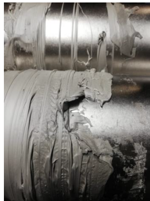
Figura 4. Imagen durante el proceso de homogenización de componentes en molino de rodillos. Velocidad de rodillo de aproximadamente 1100 rpm y a una temperatura de rodillo de 20-30°C
