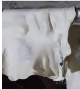
Figura 3. Láminas de goma de mascar después de sucesivos lavados como tratamiento previo al proceso de vulcanización.
