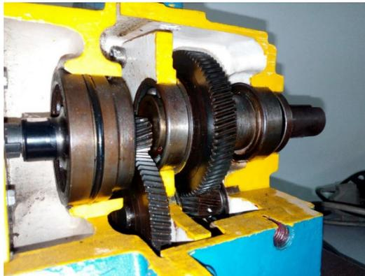
Figura 5. Tren de engranajes compuesto de reductor de velocidad.
