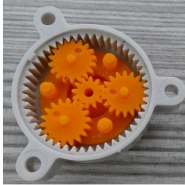
Figura 4. Tren de engranajes planetario usado como caso de estudio en clase.
