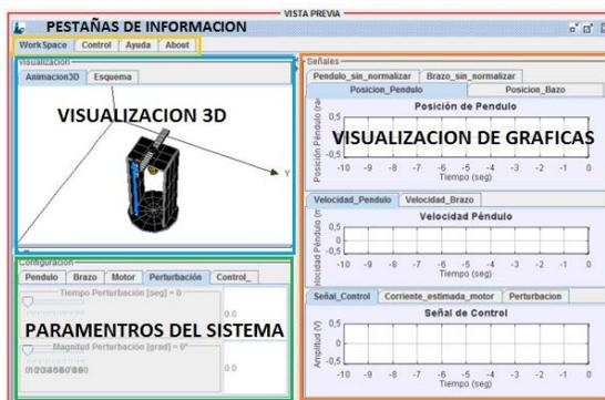
Figura 2. Interfaz de usuario para la herramienta virtual del péndulo de Furuta
