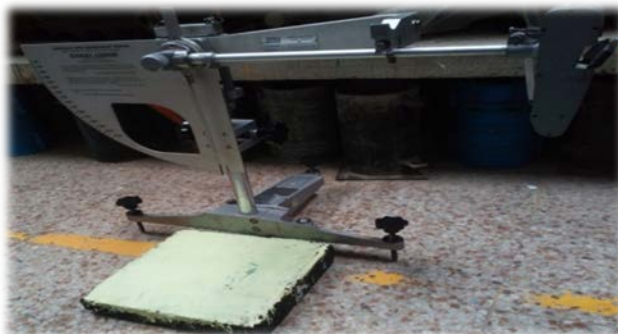
Fig. 6. Probeta en la realización del ensayo de péndulo británico.
